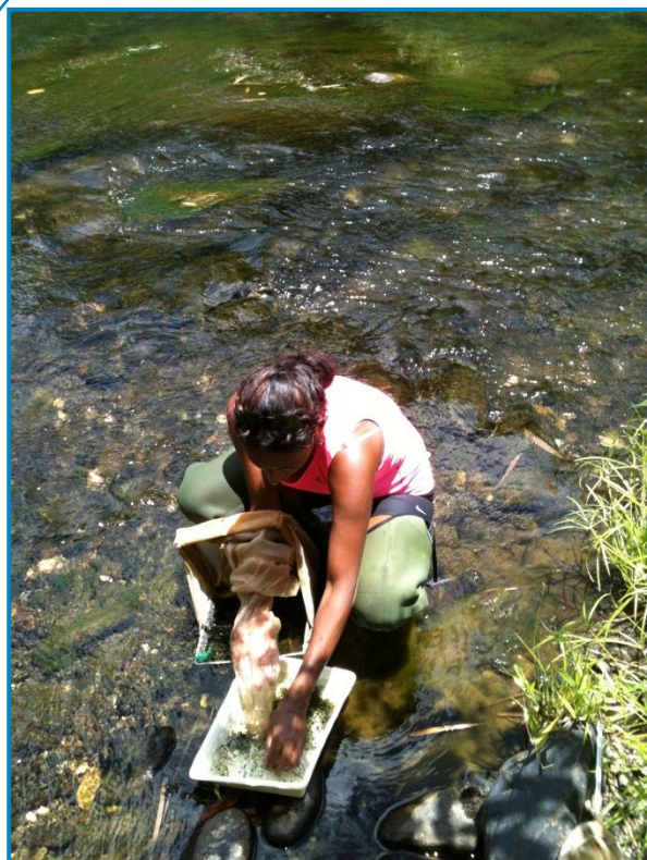
Transfert du prélèvement réalisé au filet Surber dans une cuvette à fond plat avant conditionnement.
